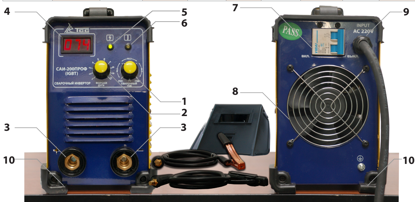
1 - регулировка сварочного тока; 2 - регулировка форсажа дуги; 3 - выводы для подключения кабеля; 4 - цифровой дисплей; 5 - индикатор сети; 6 - индикатор перегрузки; 7 - автомат защиты сети; 8 - вентилятор; 9 - кабель; 10 - резиновые углы.
